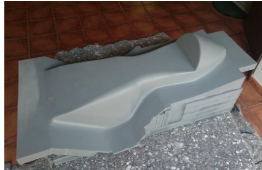
Figura 7. Modelo fabricado en MDF mediante mecanizado CNC.
