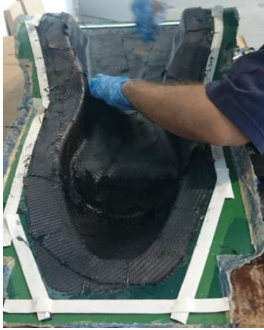
Figura 9. Laminado del colín de carbono.
