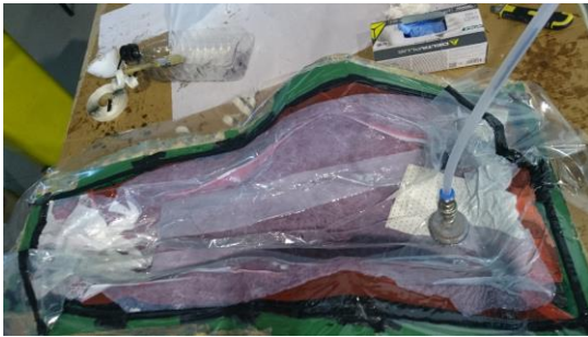
Figura 10. Compactado mediante bolsa de vacío.
