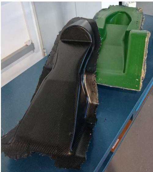
Figura 11. Pieza final antes de recantado.
